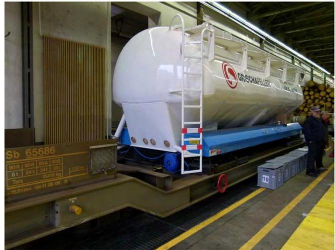
Tragwagen mit Wechselaufbauten der Rhätischen Bahn.
