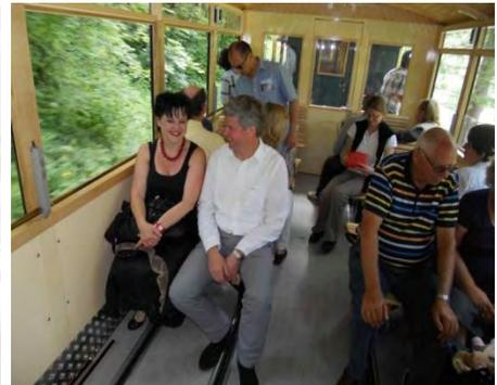
Bei der Bregenzerwaldbahn wurden auf Güterwagen-Untergestellen neue Wagenkästen in moderner Bauweise, aber traditionellem Aussehen aufgebaut. Einer der Wagen erhielt auch einen hydraulischen Hebelift für Rollstühle. In diesem Multifunktionswagen wurden die Sitze in Schienen verschiebbar befestigt, damit eine wechselnde Anzahl Rollstühle befördert werden kann. Fotos: Otfried Knoll
