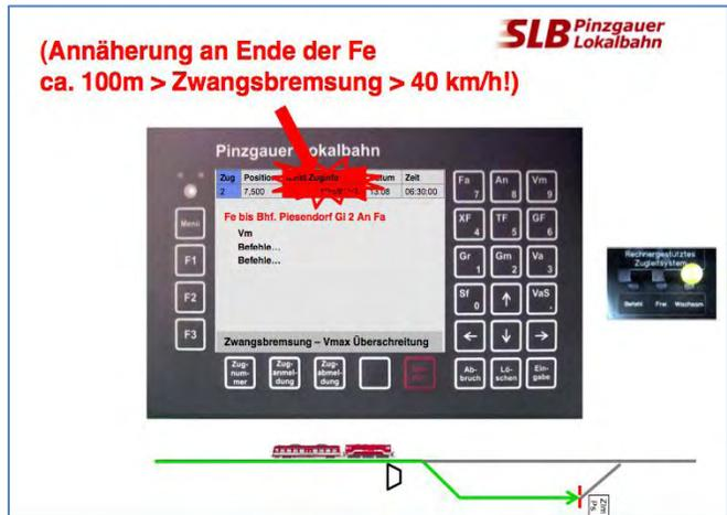
Schema der Überwachung der Einhaltung einer Fahrerlaubnis sowie der zulässigen Geschwindigkeitskurve während des Bremsvorganges mit Hilfe von virtuellen Bakens. Quelle: PLB
