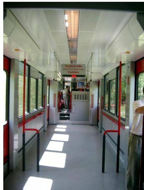
Im autofreien Ort Zermatt werden die Gepäckstücke auf „Gepäckrollis“ genannte Container geladen und in die geräumigen Rolli-Abteile der schmalspurigen Panorama-Pendelzüge gerollt.
