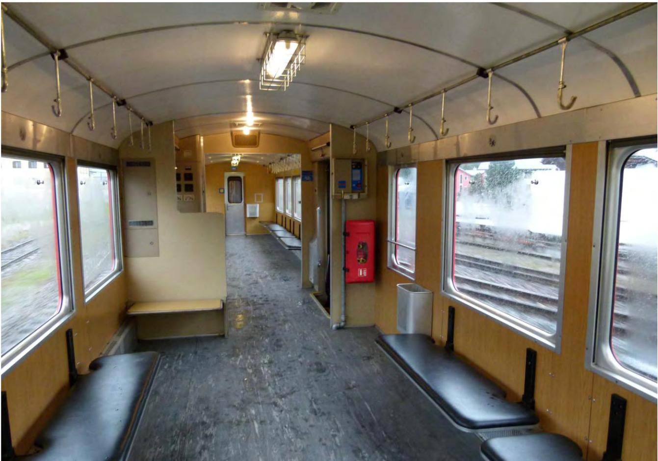
Aus einem Personenwagen der RhB umgebauter, in der Längsrichtung durchgehend begehbare Fahrradwagen.
