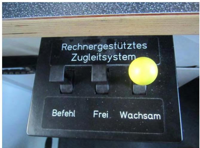
Modernes, mit dGps und passiven Balisen unterstütztes rechnergestütztes Zugleitsystem der Pinzgaubahn mit Bremswegüberwachung und Kollisionsschutz. Eine sehr ähnliche Ausführung wird bei den Stern & Hafferl - Bahnen eingesetzt. Fotos: Otfried Knoll
