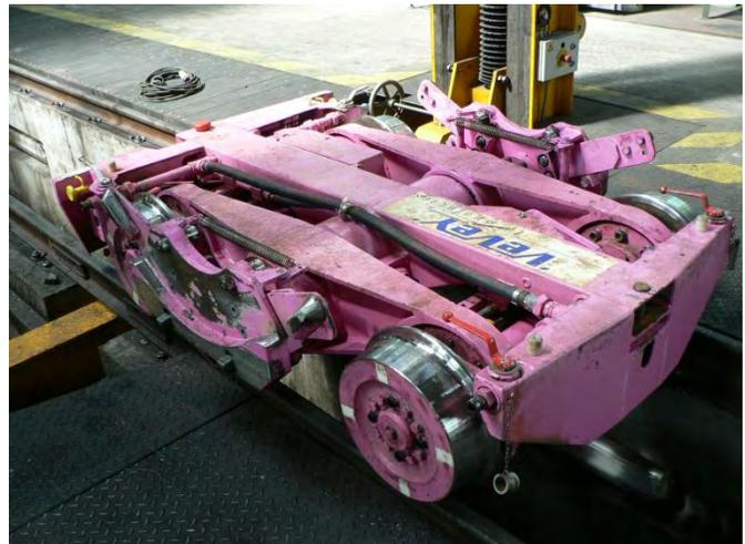
Rollwagen der Zillertalbahn mit Containerrahmen mit Rungen für den Holztransport (links), Rollbock der Bauart Vevey der Harzer Schmalspurbahnen (rechts).
